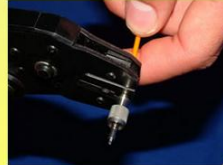
Tercer paso: crimpar el conector.
